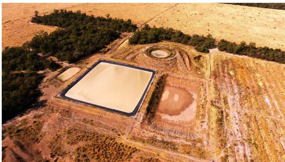
**Figura 13: Vista aérea de la represa impermeabilizada, área de captación del agua de lluvia y tanque de tierra elevado desde donde se distribuye el agua a bebederos.**
